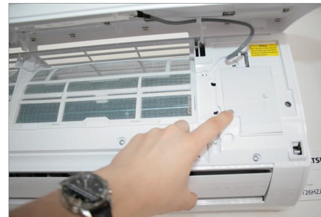
**2** Открутите винт крышки блока управления кондиционера.
